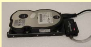
Conexión de disco IDE
